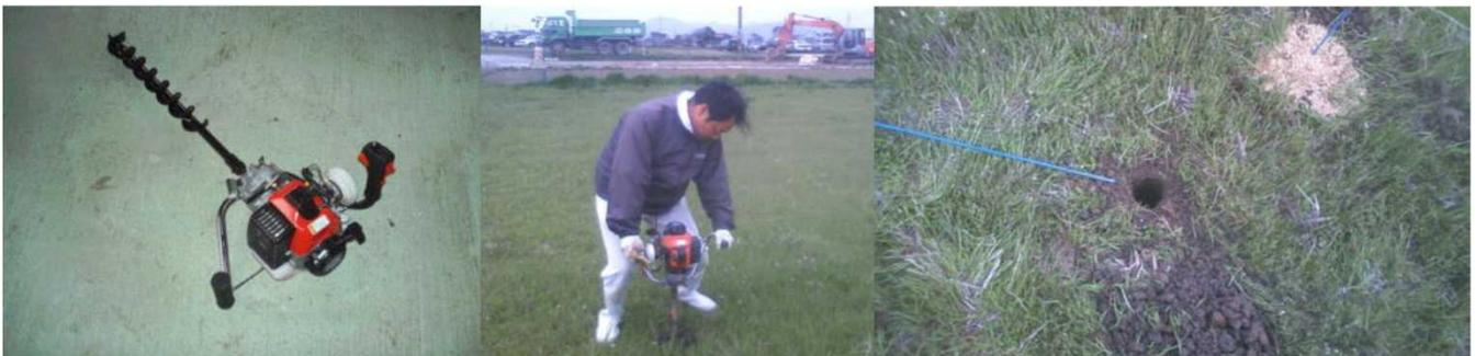
図1 供試した携帯型穴掘機(左)、穴掘り作業の様子(中)と穴及び籾殻充填(右)
