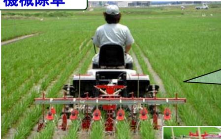
○田植後から7～10日間隔で、2～3回程度、水田除草機を稼働させます。
