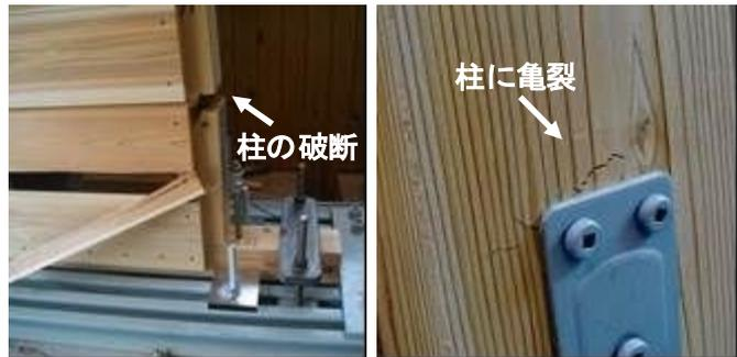
図-3 柱の破断状況
