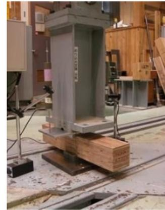
図 2 めり込み試験の様子
