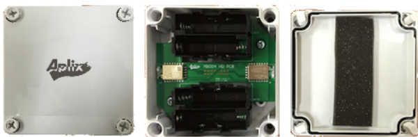
図 3: Beacon 発信機 (MyBeacon ® Pro 防水防塵型 MB004 HDc)
