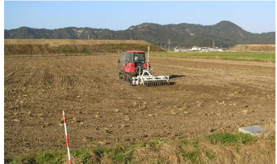
レーザーレベラーによる均平作業
