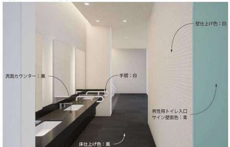
男性用トイレ：洗面カウンター
