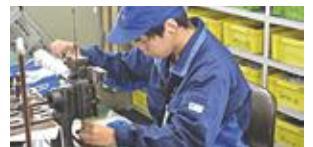
絶縁挿入作業
