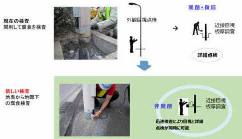
鋼板腐食検査器を使用した調査
