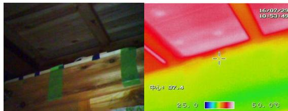
写真 3. 天井裏(設置写真・サーモグラフィ)
