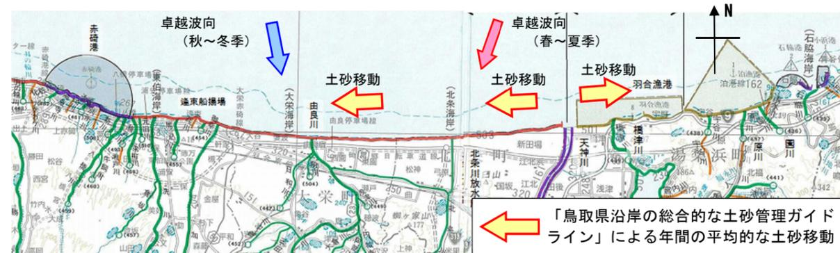
図 1.2.1 漂砂移動イメージ図
