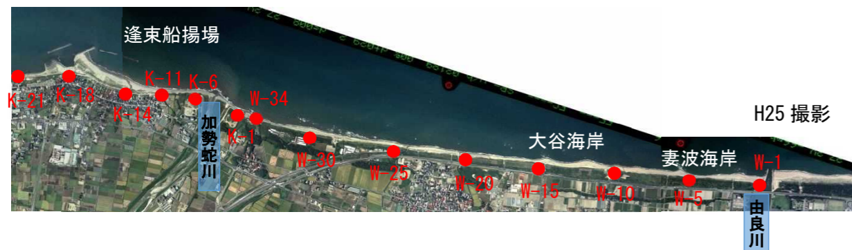
図 3.2.18 測量基点の位置 (由良川左岸地区)
