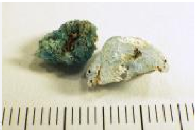
図6 溶着したガラス粒の塊（左）とガラス片（右）
