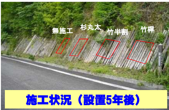
杉丸太は腐朽が進み、繊維状に崩れ始めていた
