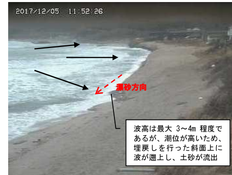
図 3-9 左図：CCTV 画像で確認される主な入射・遡上状況、右図：潮位と有義波高の関係
