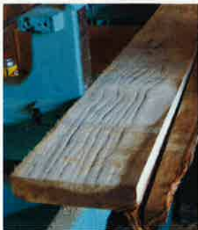
図 2 材面に生じた 筋状の落ち込み
