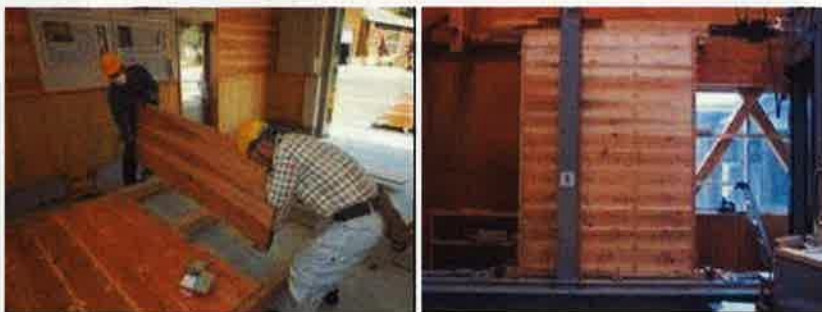
図-2 壁試験体の製作状況と実大壁試験
