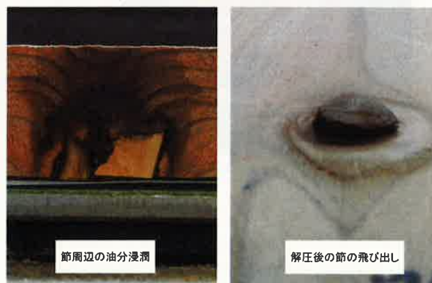
図4 有節材の圧密による不具合
