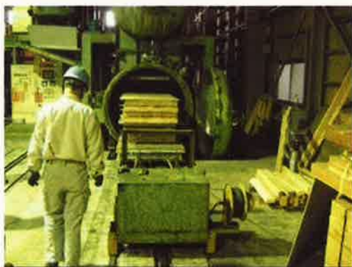
図1 CLTの薬剤注入処理
