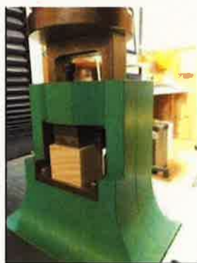
図3 接着性能試験（ブロックせん断試験）
