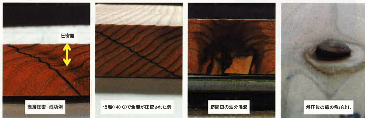
図3 加熱圧密による原料板の圧縮
