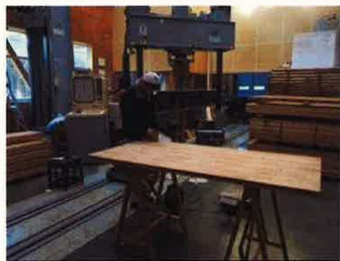
図2 注入処理後のCLTの外観等調査
