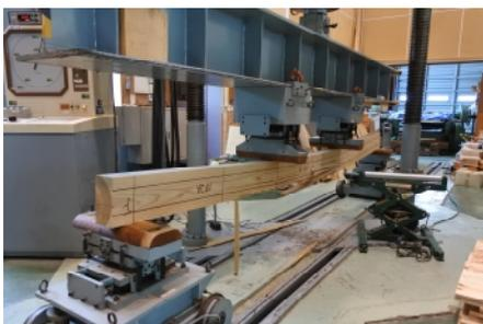
図3 曲げ試験の様子
