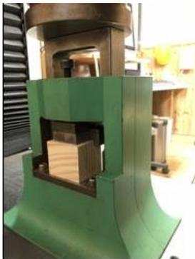
図 3 接着性能試験 (ブロックせん断試験)
