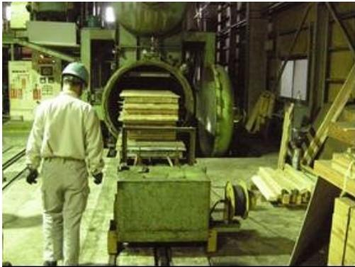
図 1 CLT の薬剤注入処理
