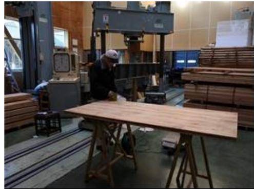
図 2 注入処理後の CLT の外観等調査
