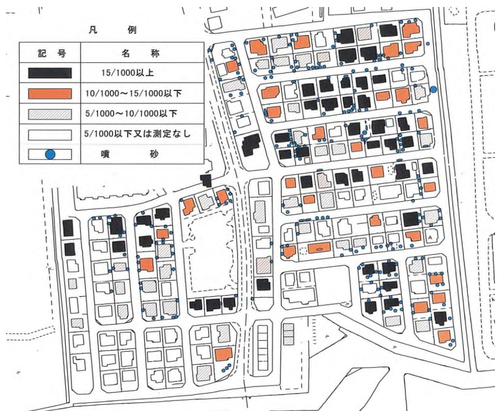
図 5.1-1(3) 噴砂発生地点と家屋の傾斜角の分布
