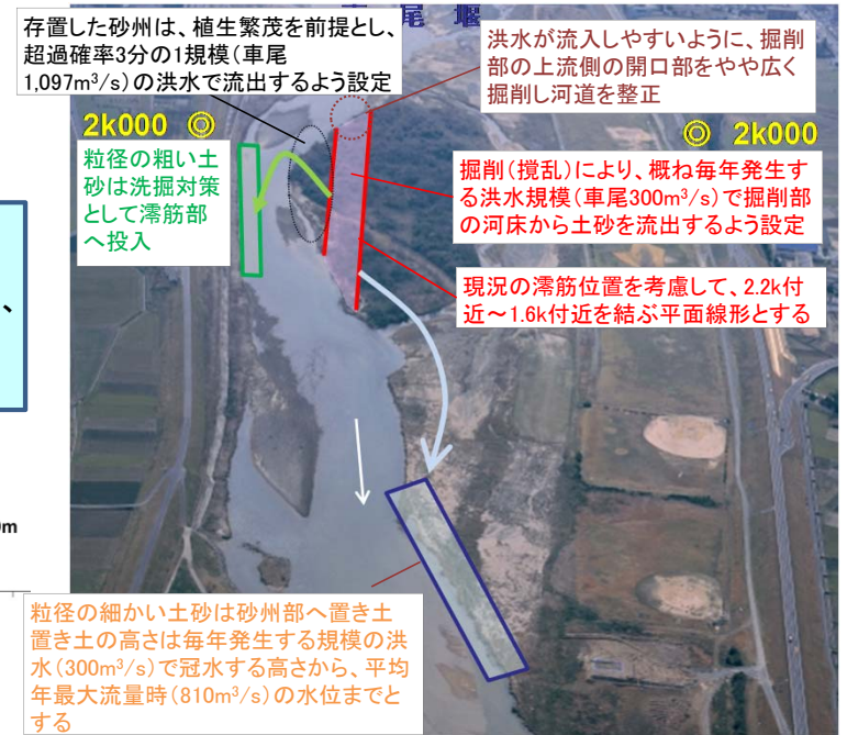
2.0k付近における河道掘削+置き土
