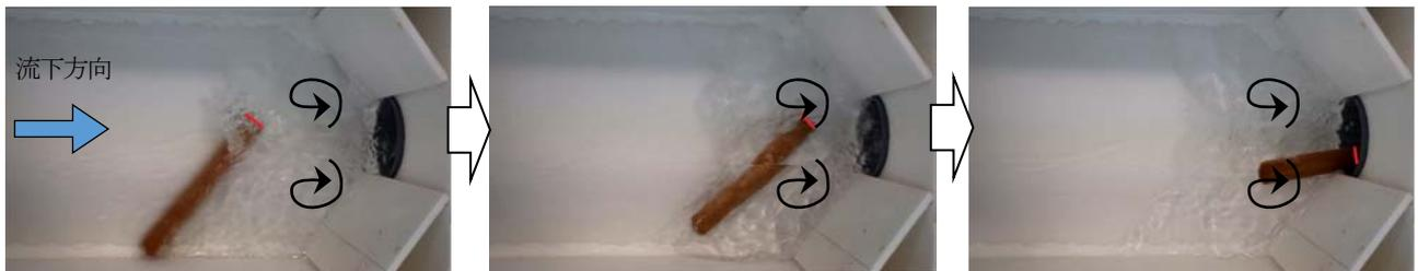
写真 b) ウイング角度40° : 呑口周囲の渦流 (写真中の黒矢印) は小さく、丸棒はスムーズに流下する
