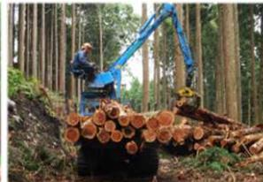
原木丸太をグラブクレーンで荷台に積んで運ぶ集材専用の自走式機械
