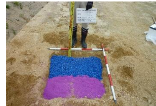
トレーサ設置状況
