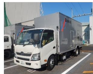
高圧発電機車
