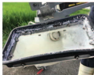
散布装置目詰まり
