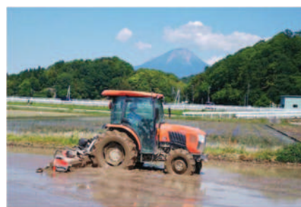
写真 GPSガイダンスを利用した代かき
