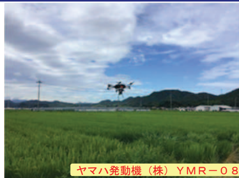
写真 ドローンによる施肥
