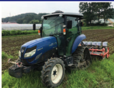
写真 自動操舵システムを利用した大豆播種作業
