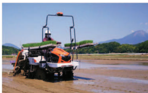
写真 直進キープ・条間アシスト・株間キープ・施肥量キープ機能付田植機
