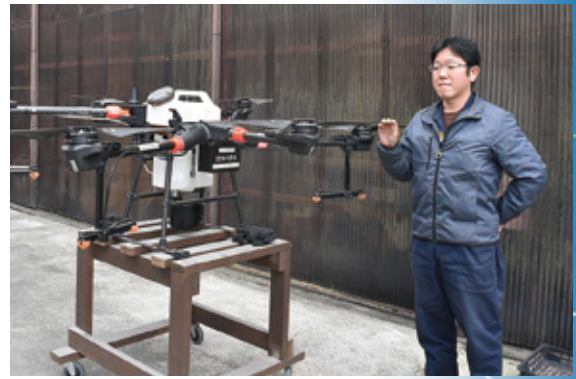
空中から肥料を散布する農業用ドローン。中央に液肥の入ったタンクを載せている
