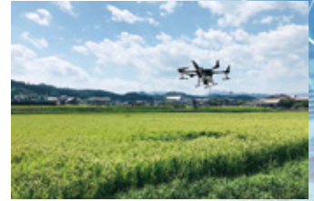
空中から肥料を散布する農業用ドローン。中央に液肥の入ったタンクを載せている
