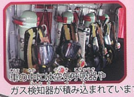
車の中に空気を吸ったりガス検知器が積み込まれています
