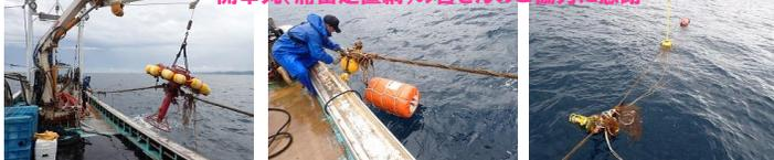
ゼニライトブイの点検の結果、不具合の原因は、潮流ブイ表面のソーラーパネルから充電池に電力を送るケーブルが削られたような形で断線したものとこと。悪さしたのは、右の漂流物(韓国のフロート付きロープ)。この漂流物が潮流ブイに絡み、運悪くロープがケーブルを横切る形となり、これが波浪により擦れ、断線したものと考えられます。
