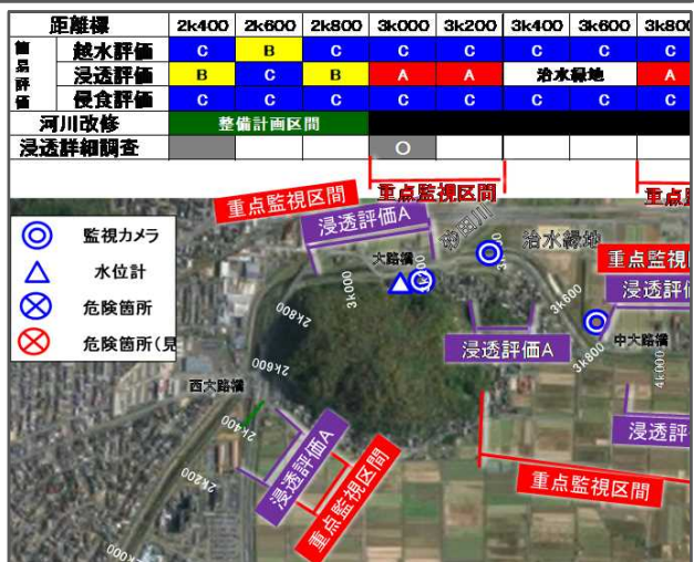
簡易評価等をもとにした重点監視区間
