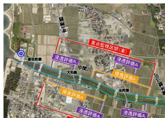
簡易評価等をもとにした重点監視区間
