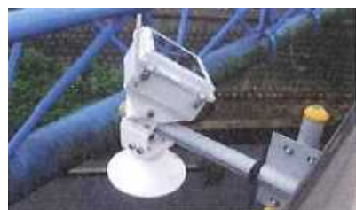
低コスト型水位計の設置例
