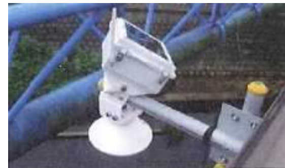
低コスト型水位計の設置例
