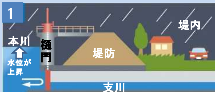
① 樋門を閉鎖し本川から支川への流入を防ぎ堤内の家屋浸水を防ぐ
