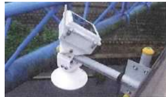
低コスト型水位計の設置例
