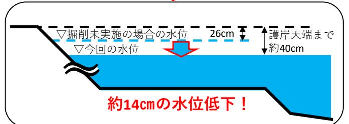
令和3年7月8日、氾濫に迫る洪水が発生したが、事前に行われた河道掘削の効果により、河川水位の上昇を抑えることができたと考えられる。
