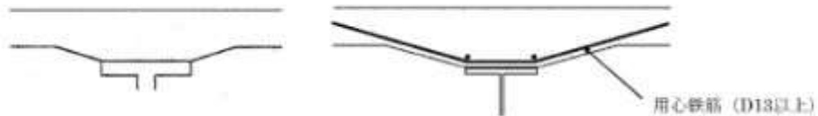
図 10-5-23 左図（ハンチ内に埋め込まない構造）、右図（ハンチ下面の用心鉄筋）
