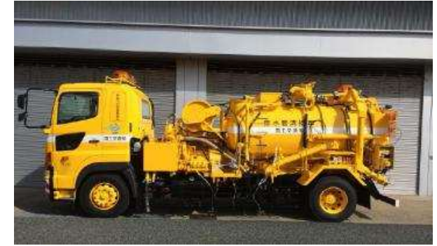
鳥取市湖山町西（鳥取維持）に待機中の排水管清掃車
