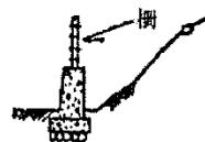
図 11-27 柵と併用されたコンクリート擁壁
