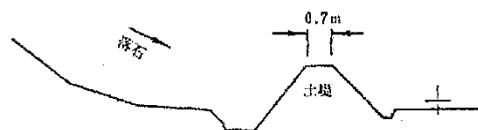
図 11-16 落石防護土堤の例
