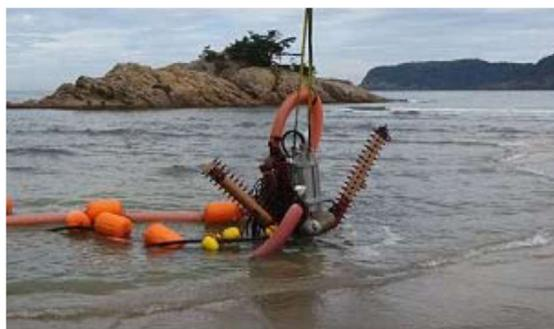
写真-3 効率よく砂を吸引して効果的なサンドリサイクルを目指すため開発されたサンドポンプ
