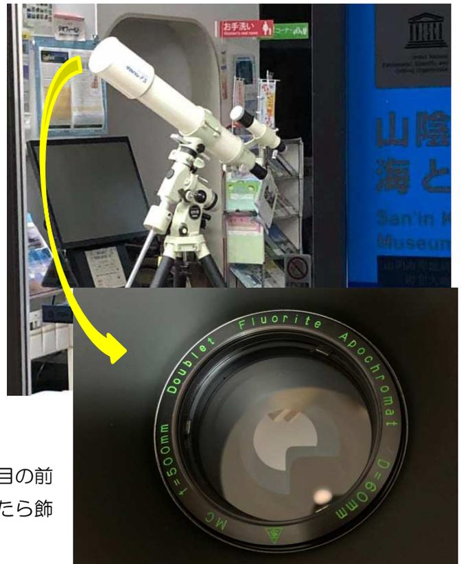
写真3 蛍石レンズが使われている望遠鏡
