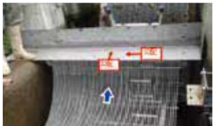
回転機の外側に取付けた円形スクリーンで塵芥を受け止め、回転機の外側に取付けたレーンで塵芥を掃き上げる。
