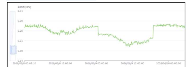
6月9日漏水発生時の水圧変動
