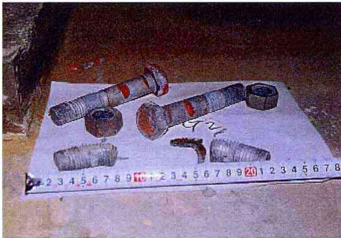
写真 4-2 破損したセットボルト
