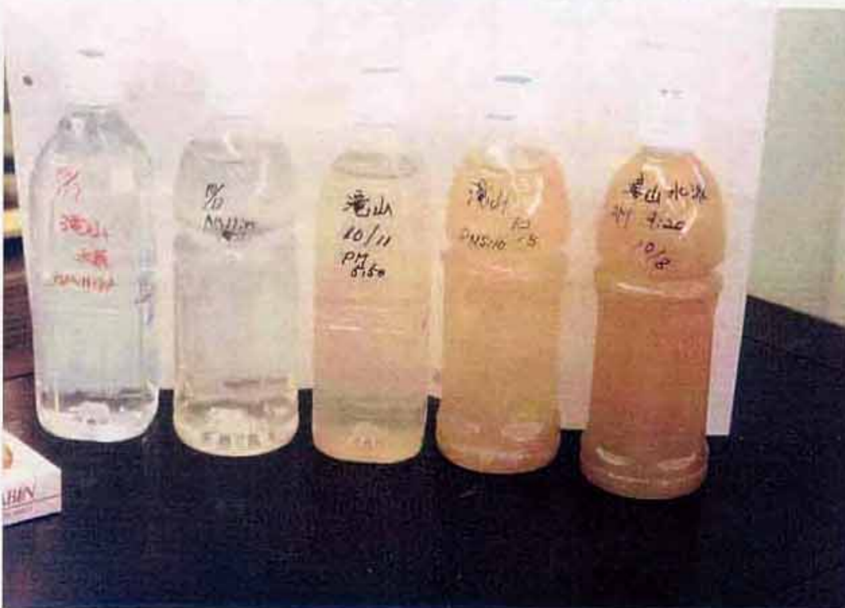
写真3.2 会見町滝山水源水の濁り
