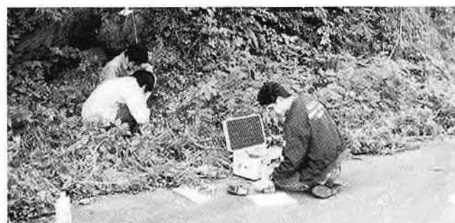
写真 地震計の設置
