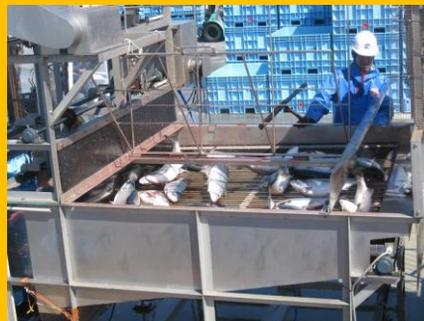
完成した電気ショック沈静化装置
