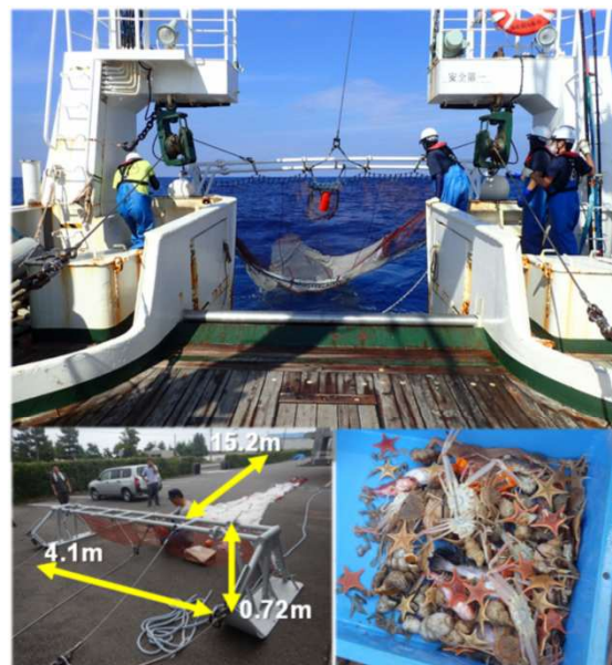
（写真）大型桁網の仕様と大型桁網で採集された生物（稚ガニも含む）
