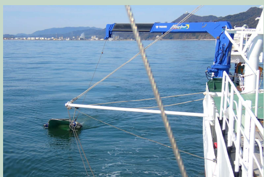
ニューストーンネット (網口幅1.3m、海面を曳網)
