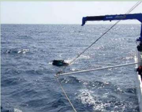
ニューストンネット (網口幅1.3m、海面を曳網)
