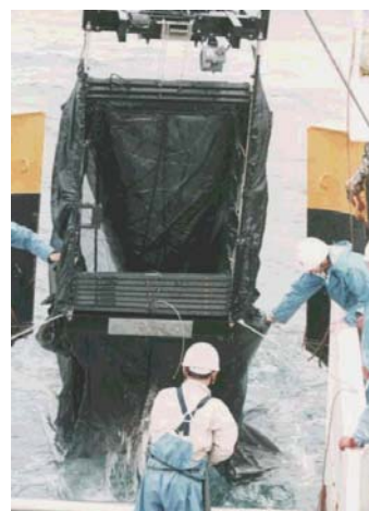
図4 スルメイカ幼生採集に用いたMOCNESS (BESS-1), 船上 (左図) と観測の様子 (右図)
