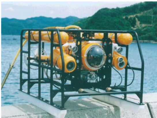
図5 スルメイカ卵塊探査に用いたROV (KOWA Expert NOVA: 左図) と卵塊探査の模式図 (右図)。船体とROVの漂流差を小さくするためにパラアンカーを用いた
