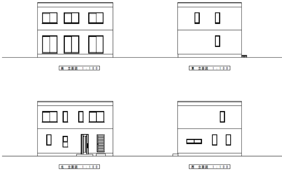
立面図(鉄筋コンクリート造)
