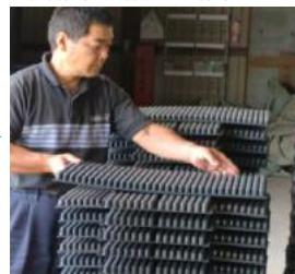
トレーに破損がないか確認しつつ、水切りし、乾燥のためにバランスをとりながら交差するようにトレーを積み上げる。
