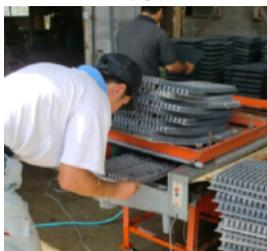
洗浄機にトレーの上面を下にして挿入する。
