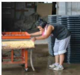
洗浄機内では流水によりトレーが洗浄される。送り出されるトレーを受けとり、次の作業者に渡す。
