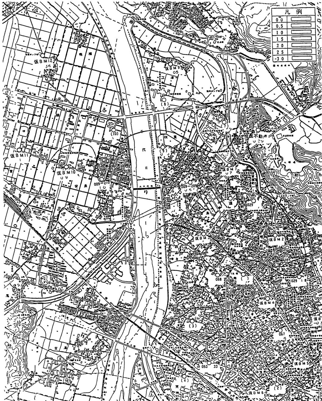
凡例 平成元年7月～平成2年7月の沈下等量線 ○水准点
